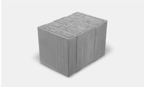
Der ThermoPlan® MZ 60 Planstein wird mit einem Dünnbett-mörtel mit einer Fugenstärke von 1-3mm verklebt. Der zum System passende Dünnbettmörtel wird mitgeliefert.
