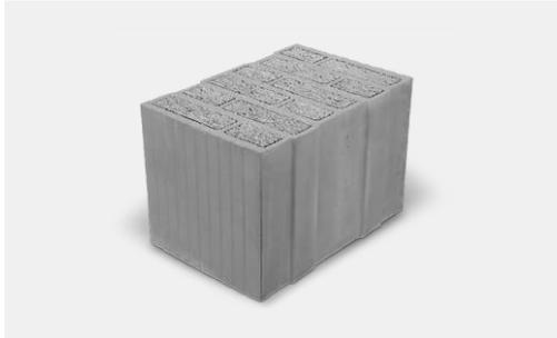
Der ThermoPlan® MZ 65 Planstein wird mit einem Dünnbett-mörtel mit einer Fugenstärke von 1-3mm verklebt. Der zum System passende Dünnbettmörtel wird mitgeliefert.
